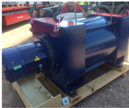
Tausch eines Generators einer VESTAS V 80 Windenergieanlage im Rahmen eines Vollwartungsvertrages der StiegeWind GmbH
